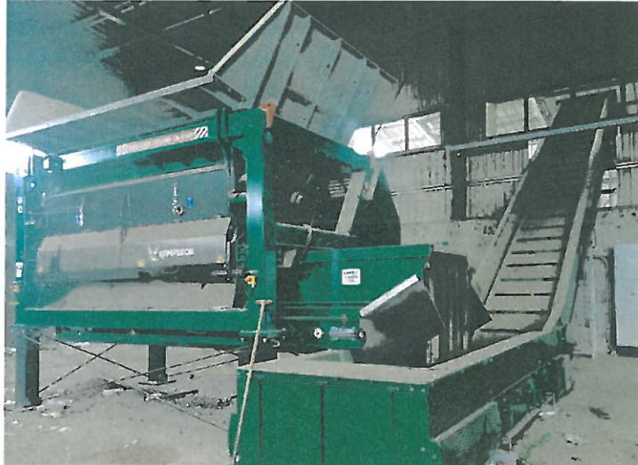
Fotó: Újonnan üzembe helyezett előaprító berendezés munka közben
